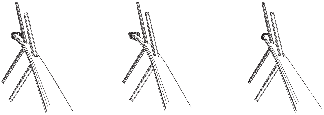
Korrekt placerad mastfot.
