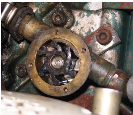
Bild 5.7, bakom locket sitter impellern. På vår motor sitter numera sk "Pin Wings" med vingmuttrar som gör att man kommer åt mycket enklare när man ska jobba med vattenpumpen.
