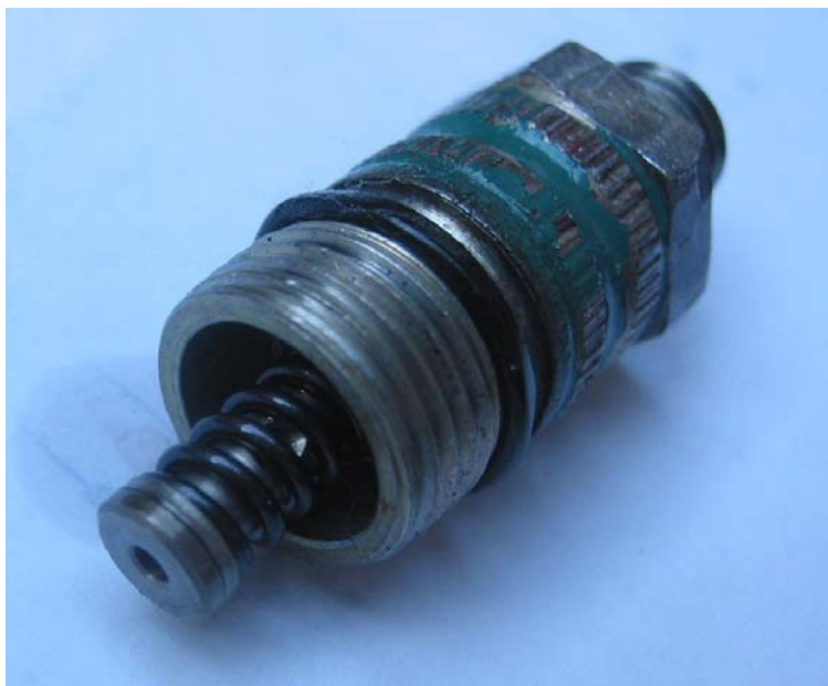
Bild 2.22, Delar i tryckventilförslutningen, Plugg med bricka och fjäder nr 5, 6 och 7 (bulten med en fjäder) är har suttit på detta sätt i vår motor vilket är fel, men har fungerat i alla fall. "Hatten" på pluggen ska vara vänd åt andra hållet. Notera även den svart O-ringen som kan behöva bytas efter några år.
