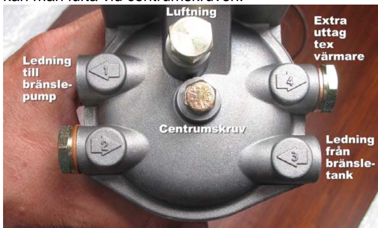
Bild 2.1, Överdelen på förfiltrets hållare (CAV) som monterades sommaren 2006. Notera att man aldrig ska peta på luftningsskraven om man har en sugpump vid motorn, vilket alla MD5:or har.
