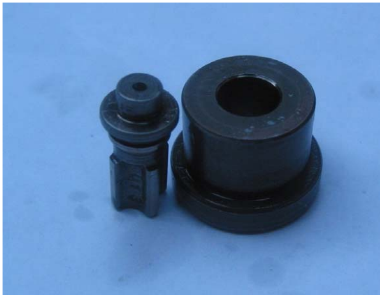
Bild 2.21, Tryckventilen (nr 9) består av två delar. Den vänstra stoppas ner i hålet på den högra. Kopparpackningen tätar mot nederdelen på den fjäderbelastade pluggen.
