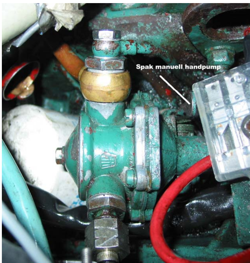
Bild 2.8, matarpump (bränslepump) med handtag för manuell pumpning (handpump) vid luftning.
