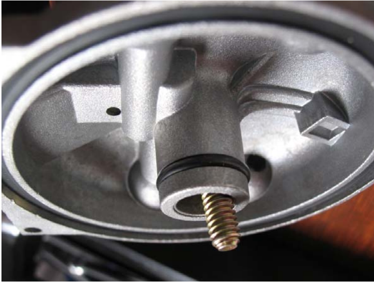
Bild 2.2, Förfilter, här ser man var O-ringen som är ca 2 cm i diameter sitter. I yttre spåret ser man en av de stora O-ringarna. I mitten den lilla O-ringen. .
