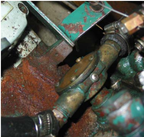
Bild 5.6, bakom locket 4 skruvar sitter impellern. Vattenpumpen sitter bökiigt till på baksidan av motorn. För att förenkla byte kan man med fördel montera sk "Pin Wings" vilket förenklar både montage och demontage.
