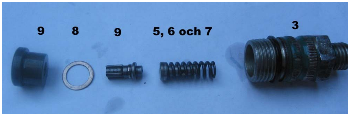
Bild 2.20, bild på tryckventilförslutningen på högtryckspumpen och delarna som "ligger löst". Siffrorna visar delarna enligt sprängskissen bild 1.8. OBS pluggen med bricka och fjäder (5, 6 och 7) är felvända på bilden.
