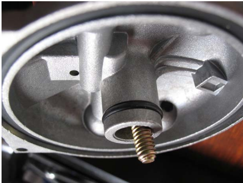
Bild 2.2, Förfilter, här ser man var O-ring som är ca 2 cm i diameter sitter. I yttre spåret ser man en av de stora O-ringarna. I mitten den lilla O-ring.
