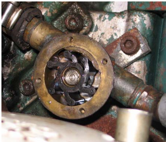
Bild 5.7, bakom locket sitter impellern. På vår motor sitter numera sk "Ping Wings" med vingmuttrar som gör att man kommer åt mycket enklare när man ska jobba med vattenpumpen.
